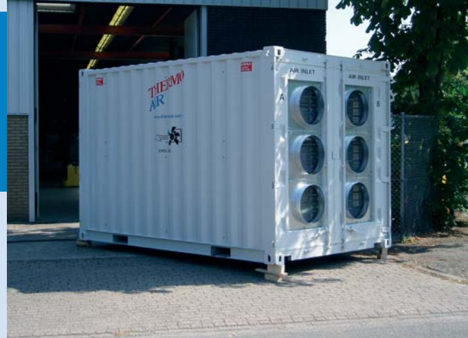
Omgebouwde zeecontainers voor 350 kW mobiel koelvermogen
