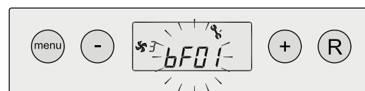
Vergrendelende systeemventilatorcode; storingsweergave knippert, verlichting aan
