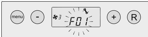
Vergrendelende storing; toestel storing Storingsweergave knippert
